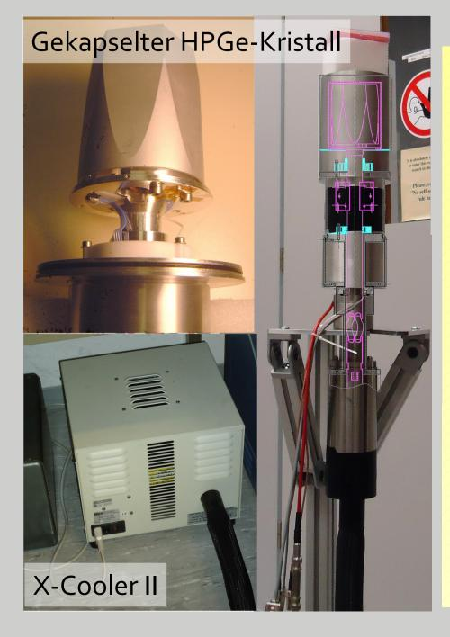
Innerhalb des PANDA-Detektors ist in radialer Richtung der zur Verfügung stehende Platz durch den Durchmesser des Spurdetektors beschränkt. Deshalb ist es geplant, die sperrigen LN2-Dewars durch eine kompaktere Kühlung basierend auf dem Stirling-Kreisprozess zu ersetzen (z.B. Ortec® X-Cooler II).
