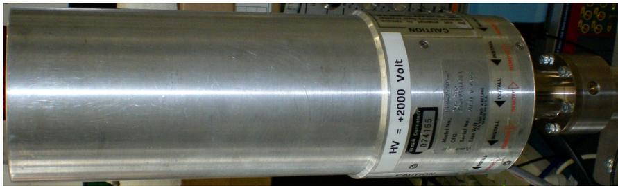
**Abbildung (4.2):** Verwendeter HPGe-Detektor ORTEC® GEM 75205 P
